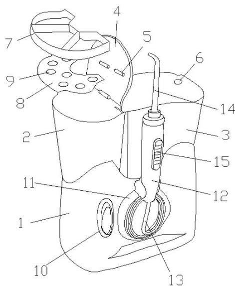
1. 一种口腔清洗器,其特征在于:包括主机、储藏盒和水箱,所述储藏盒和水箱设在主机上,所述储藏盒和水箱分别与主机卡持连接,所述储藏盒上设置有端盖,所述端盖与储藏盒铰接,所述端盖上设置有紫外线灯,所述水箱上设置有注水口,所述储藏箱内设置有隔板和插槽板,所述插槽板上设置有插槽孔,所述隔板和插槽板分别与储藏箱卡持连接,所述主机上设置有电源开关和固定圈,所述固定圈上设置有手柄,所述手柄下端设置有水管,所述手柄上设置有喷管。
