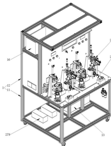
1. 一种座式洁牙器多工位全功能测试机,其特征在于:包括机架,所述机架包括工作机架及设于所述工作机架上的控制机架,所述工作机架内设有用于给所述洁牙器供电的变频变压电源,所述工作机架上设有多个测试机构,所述控制机架上设有控制装置、显示装置以及多个电参数表,所述测试机构、显示装置、电参数表均与所述控制装置电性连接,所述控制机架内还设有供水水箱;
