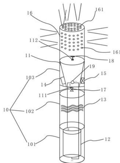
1. 一种微米/纳米级氢气喷射口腔清洁仪,其特征在於,包括壳体和膨化器,所述壳体呈笔直圆柱状,且该壳体内部由下至上依次分隔成容纳电池的下密封腔体、盛装有纯氢气的氢气储水腔体和用于放置膨化器的上膨化腔体;所述膨化器放置在该上膨化腔体内,且该上膨化腔体内还容纳有小马达和微型隔膜泵,且该小马达和微型隔膜泵设置在膨化器的外围上;所述壳体的顶端上设有可直接伸入口腔内的喷嘴,且该喷嘴上均匀分布有喷射孔,该喷射孔为纳米喷射孔或微米喷射孔;所述膨化器分别与氢气储水腔体和喷嘴相通;所述电池与小马达电连接,且所述小马达与微型隔膜泵驱动连接。
