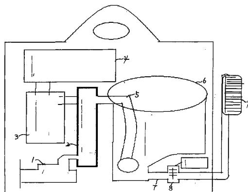
1. 一种三氧水口腔牙齿康疗仪,包括气泵 [1]、氧源发生器 [2]、导气管 [5]、水瓶 [6]、牙刷头 [9],气泵 [1] 与氧源发生器 [2] 相连接,其特征在于所说的牙齿康疗仪的氧源发生器 [2] 连接有增压器 [3];氧源发生器 [2] 的导气管 [5] 与水瓶 [6] 连接;水瓶 [6] 下端的出水管 [7] 通过水泵 [8] 与牙刷头 [9] 连接。
