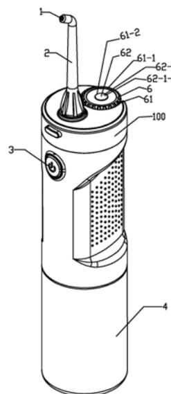
1. 含水量无级调节装置的牙齿冲洗器,其特征在于:所述含水量无级调节装置的牙齿冲洗器(100)含喷头(1)、喷枪(2)、控制开关(3)、容器(4)、水管(5)及水量无级调节装置(6);
