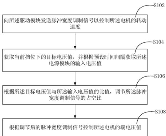
1. 一种冲牙器的输出控制方法,用于控制所述冲牙器的输出水压,其特征在于,所述冲牙器包括电源模块、电机与驱动模块,所述电机的一端与电源模块电连接,所述电机的另一端与驱动模块电连接;所述方法包括:
