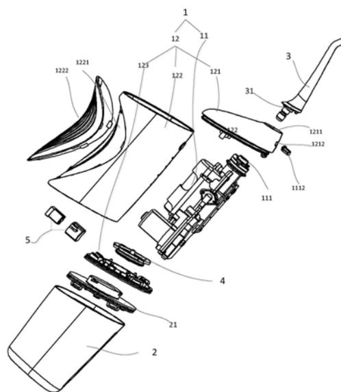
1. 一种冲牙器,包括机身、水箱及喷嘴,其特征在于:所述机身顶部的出水口位置设置有与所述喷嘴卡接的连接头,相应的,所述喷嘴的底端设置有与所述连接头适配的连接部,所述连接头包括用于卡接所述喷嘴的卡簧及胀开所述卡簧方便所述喷嘴取出的锁扣,所述连接部包括用于与所述卡簧卡接的连接柱及位于所述连接柱侧面的定位桩,所述连接柱上设置有与所述卡簧适配的卡槽,所述连接柱的自由端的边缘设置有方便插入所述卡簧内的坡面。
