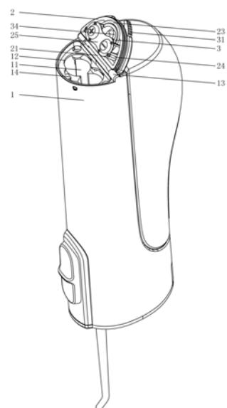
1. 一种洗牙器的便捷电池盖结构，包括机身，所述机身尾部设有电池仓，电池仓的拆卸口上设有尾盖，
