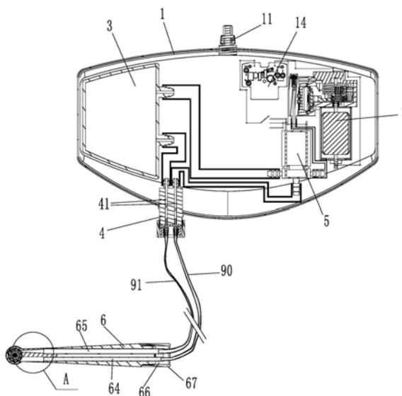
1. 一种洗牙舒适的台式冲牙器,其特征是,包括驱动台组件和牙刷喷嘴组件;所述驱动台组件包括第一壳体,第一壳体上固定设有出液管;第一壳体内设有储液箱、气压泵、止回阀和驱动开关,驱动开关电路控制气压泵和止回阀;止回阀通过管道分别连接气压泵、储液腔和出液管;出液管内设有两个贯通长孔,两个贯通长孔分别管道连通储液箱的输出端和止回阀的输出端;所述牙刷喷嘴组件包括第二壳体,第二壳体外设有毛刷;第二壳体的内部设有涡轮腔,涡轮腔内设有可转动的涡轮叶,涡轮叶和毛刷轴线平行,毛刷与涡轮叶的轴线固定,第二壳体上还设有分别对应出液管两个贯通长孔的气体腔和液体腔,气体腔和液体腔的出口端分别正对涡轮叶的叶片,第二壳体上还设有连通涡轮腔和外界的喷嘴孔。
