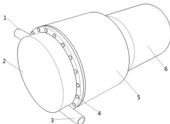
1. 一种用于磁泵的钕铁硼磁体，包括进液口、泵盖、出液口、螺栓、联接架、驱动电机、叶轮、转轴、内磁钢总成、隔离套、内隔离套、外隔离套、螺栓、挡板、圆管磁体、圆管磁体架；其特征在于：所述隔离套由内隔离套、外隔离套组成，在内隔离套、外隔离套上均设有螺纹，其中内隔离套通过螺纹连接与外隔离套连接，其中隔离套通过螺栓与泵盖连接，在隔离套内孔中安装着内磁钢总成，在内磁钢总成的左侧设有叶轮，其中叶轮通过转轴与内磁钢总成连接，在隔离套上套有外磁钢总成，其中外磁钢总成由螺栓、挡板、圆管磁体、圆管磁体架组成，其中圆管磁体固定安装在圆管磁体架上设有的圆管磁体安装槽上，其中挡板为凸形挡板，并且挡板通过螺栓与圆管磁体架连接。
