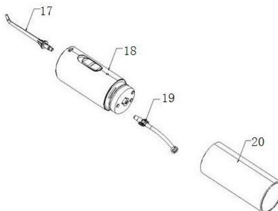
1. 一种便携式冲牙器,其特征在于,所述冲牙器包括喷嘴组件、主机、水管接头组件以及水箱组件,所述喷嘴组件设置在主机上,所述水管接头组件连接主机,所述水箱组件与主机连接,所述主机包括主壳体、设置在主壳体内部的核心组件以及底壳,所述底壳设置在主壳体上,所述水管接头组件包括水管接头、水管以及过滤组件。
