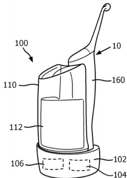
1. 一种对接和充电站,用于接收、充电和填充用于牙科清洁的手持式液滴装置,所述对接和充电站(100)包括:
