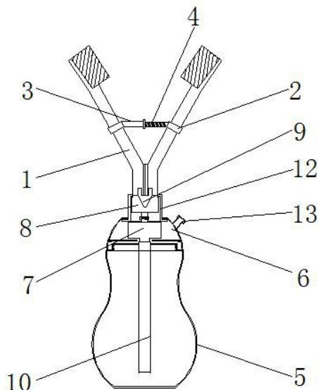
1. 一种用于口腔修复的清洁擦洗器，包括刷头(1)、储水瓶(5)、出水口(11)和第二固定环(15)，其特征在于：所述刷头(1)的外壁套设有第一固定环(2)，且第一固定环(2)的边侧固定有套筒(3)，并且另一第一固定环(2)的边侧设置有调节杆(4)，所述储水瓶(5)的顶部安装有瓶盖(6)，且瓶盖(6)设置于刷头(1)的下方，所述瓶盖(6)中设置有水泵(7)，且瓶盖(6)的外表面预留有药物投入口(13)，所述水泵(7)的顶部连接有蓄水室(8)，且蓄水室(8)的上方安装有分水器(9)，所述水泵(7)的底部固定有抽水管(10)，且水泵(7)与抽水管(10)连接处的边侧设置有挡板(14)，所述出水口(11)位于刷头(1)上方的边侧，且刷头(1)的底部安装有固定器(12)，并且固定器(12)的底部设置于瓶盖(6)内，所述第二固定环(15)设置于挡板(14)的下方，且第二固定环(15)固定于瓶盖(6)的内壁。
