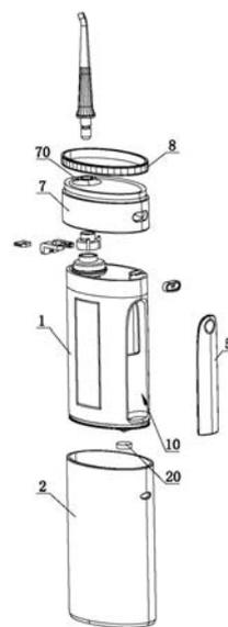
1. 带消毒功能的洗牙器,包括滑动连接的内壳体(1)与外壳体(2),其特征在于:所述内壳体(1)设有用于容置冲洗头的容置腔(10)以及设于容置腔(10)的消毒灯(11),所述内壳体(1)与外壳体(2)之间设有开关装置,当内壳体(1)与外壳体(2)相对收缩移动时所述开关装置启动消毒灯(11)。
