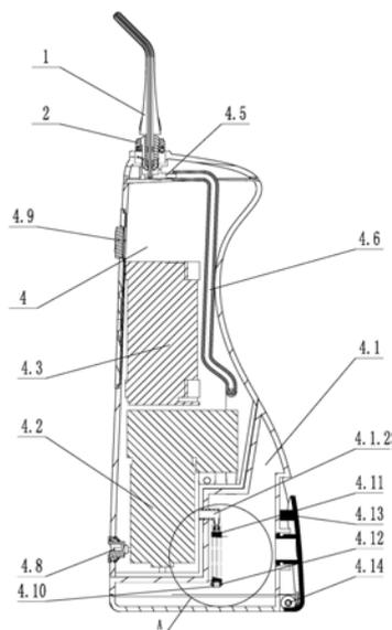
1. 一种便携式气液混合冲牙器,其特征是,包括导流管、锁紧组件和机身,所述导流管通过锁紧组件固定在机身上;所述机身内设有储水箱、气压泵、电池、供气口和供水口,储水箱上设有压气口和高压液出口,供水口通过供水管与高压液出口连通,供气口通过供气管与气压泵连通,压气口与气压泵连通;所述导流管包括导气管和导水管,导气管套设在导水管外侧且与导水管固定,导水管包括依次连通的进水口、导水腔和出水口,导水管与导气管共同围成导气腔,导气管上设有与导气腔连通的进气口和若干个与导气腔连通的出气口,进气口与供气口连通,进水口与供水口连通。
