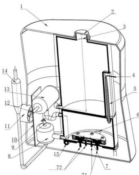
1. 一种能够提供多种水源的冲牙器，其特征在于：包括壳体，设置在壳体内的水箱，设置在水箱下部、进水口通过电磁阀与水箱出水口相连的容器，所述容器内设有检测容器水位的水位检测器，所述容器底部设有臭氧富氢发生器，所述冲牙器还包括设置在壳体上的开关旋钮和电源线、设置在壳体内的PCB板、与容器出水口相连的水泵，所述水泵的出水口通过电磁阀与冲牙器的喷嘴相连，所述PCB板分别与电磁阀、开关旋钮、电源线、水位检测器、臭氧富氢发生器和水泵相连。
